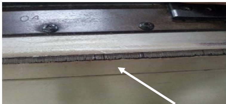
Gambar 5 Kondisi Top Comb Normal
