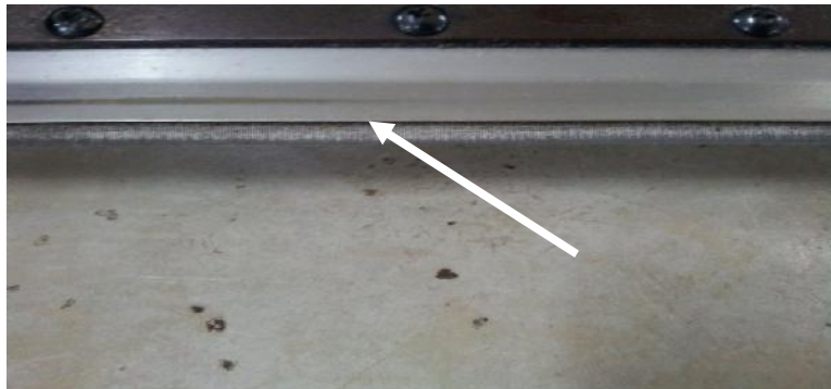
Gambar 4 Kondisi Top Comb Normal
