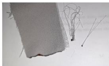
Gambar 4. Uji pembakaran pada kain Imego
