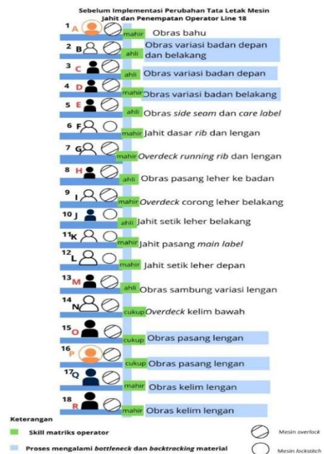
Gambar 2. Layout Penjahitan T-Shirt Wanita Style TY42217 Sebelum Penerapan Perbaikan Tata Letak Mesin Jahit dan Penempatan Operator
