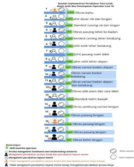
Gambar 3. Layout Penjahitan T-Shirt Wanita Style TY42217 Setelah Penerapan Perbaikan Tata Letak Mesin Jahit dan Penempatan Operator
