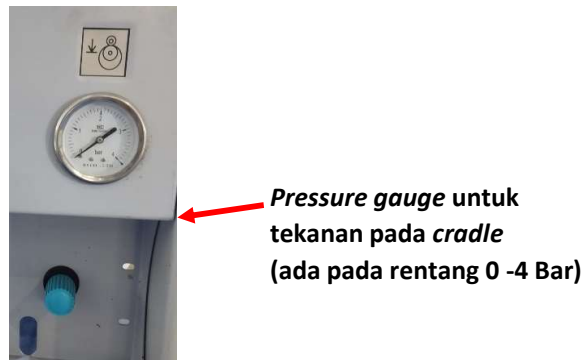
Gambar 1. Pengaturan tekanan cradle pada mesin winding Savio Polar
