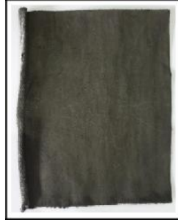
Gambar 1.5 Kain Patch yang telah dilapisi tinta konduktif
